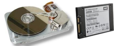
HDD mit rotierenden Magnetscheiben, rechts eine SSD
