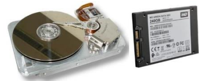
HDD mit rotierenden Magnetscheiben, rechts eine SSD
